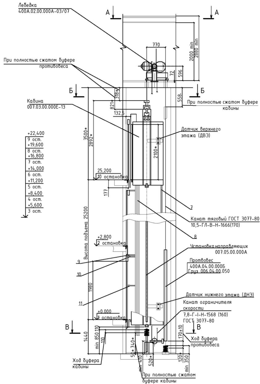
Схема расположения дверей шахты и установки направляющих
