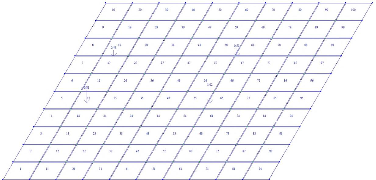
Рис. 3. Нагрузки на плиту перекрытия шахты от лифтового оборудования.
