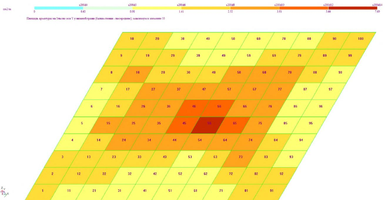
Рис. 6. Площадь арматуры на 1 пог. М по оси Y по нижней грани.
